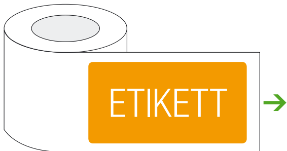
Wickelschema 3 Text rechts zuerst, Wortende voraus
